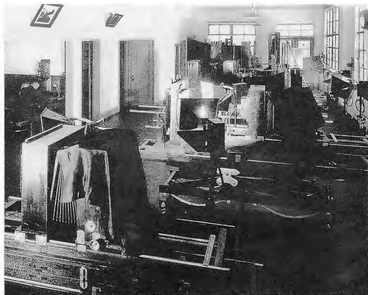
1940(昭和15)年頃の写真製版室全景。いちばん手前が凸版原版印刷用カメラ。奥がオフセット用大型カメラで暗室が直結している。(提供・光村印刷株式会社)
